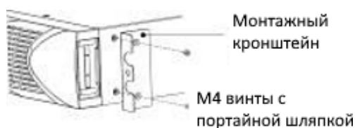
Рисунок 3 – Установка монтажных кронштейнов
